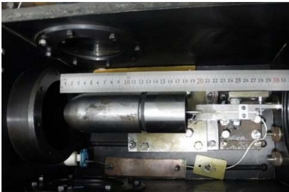
Рис. 5. Осесимметричная модель и датчик температуры торможения в рабочей части установки
