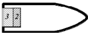
1 – корпус снаряда; 2, 3 – топливо
