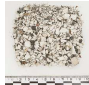
Рис. 3. Фоторегистрограмма пробития преграды из \text{Al}_2\text{O}_3 и вид фрагментов пластины после соударения при V_0 = 2443 \text{ м/с}
