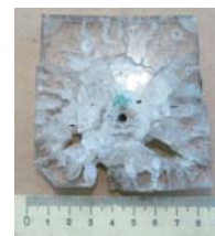
Рис. 1. Фоторегистрограмма пробития преграды из ПММА и вид лицевой поверхности преграды после пробития при V_0 = 2731 м/с
